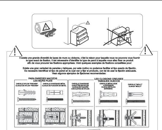
Utiliser une taile de forêt adaptée à la quincaillerie utilisée et au type de mur. Usar un tamaño de taladro adecuado según el tipo de herrajes y de pared.
